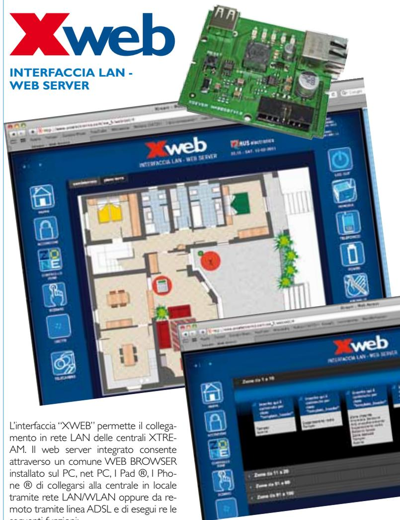
L'interfaccia "XWEB" permette il collegamento in rete LAN delle centrali XTREAM. Il web server integrato consente attraverso un comune WEB BROWSER installato sul PC, net PC, I Pad ©, I Phone © di collegarsi alla centrale in locale tramite rete LAN/WLAN oppure da remoto tramite linea ADSL e di eseguirne le seguenti funzioni:
