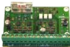
Modulo AMPLIBUS permette di isolare ed amplificare la linea seriale RS485 raddoppiando la lunghezza massima utilizzabile.
