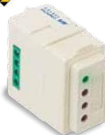
RS va collegato ad una delle RS485 della centrale con cavo a 4 conduttori. XTREAM640 può gestire fino ad un massimo di 32 lettori RS e 512 Chiavi TOUCH. Il lettore ha 4 Led di diverso colore per dare informazioni immediate sullo stato della centrale collegata ed è prodotto in modelli diversi per essere compatibile con le principali serie civili da incasso. L'acquisizione del codice della chiave avviene per "autoapprendimento". XTREAM, abbinata al lettore RS, permette:
