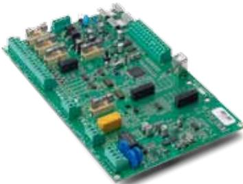
Il satellite XSATHP ha la possibilità di gestire sino a 16/32 apparecchiature direttamente connesse alla seriale RS485.
