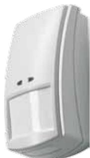
Sensore infrarosso passivo con trasmissione 868Mhz. Funziona con batteria al litio da 3 V. E' dotato di un sistema che invia una segnalazione di sopravvivenza verso la centrale, inoltre è possibile selezionare due modalità di
