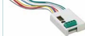
XSATMINI, abbinato ad un qualsiasi dispositivo di rilevamento e/o segnalazione cablato (sensori, contatti, sirene, ecc) permette di gestire via bus RS485 le segnalazioni di allarme, tamper, antimask ed il controllo del blocco microonda, semplificando i cablaggi necessari. Può anche essere usato come micro satellite seriale.
